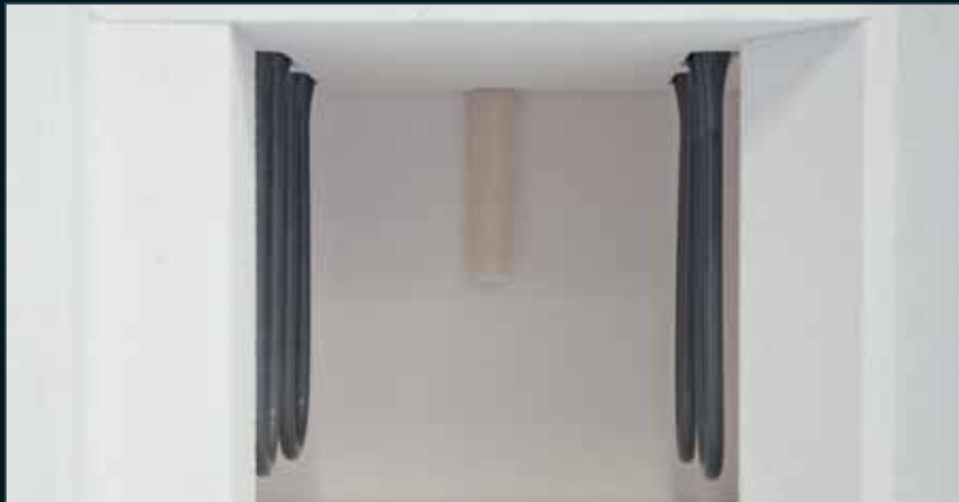
Cámara de combustión del Zirkonofen 700 con resistencias de \text{MoSi}_2
